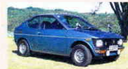
Fronte Coupé LC10W (1972-1977) Mit 37-PS-Zweitakt-Dreizylinder und Hitze-problemen
